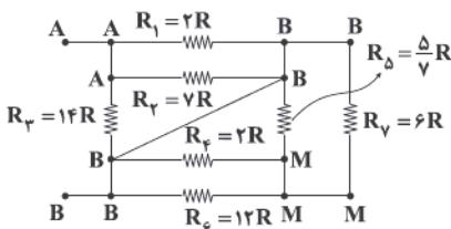
اختلاف پتانسیل الکتریکی دو سر مقاومت‌های  $R_1$ ،  $R_2$  و  $R_3$  برابر است، پس موازی هستند. مقاومت معادل آن‌ها برابر است با:
