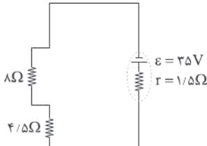
مقاومت‌های  $4/5\Omega$  و  $8\Omega$  متولی هستند، بنابراین مقاومت معادل مدار برابر است با:
