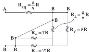
با توجه به مدار ساده‌تر، چون اختلاف پتانسیل الکتریکی دو طرف مقاومتها  $R_5$ ,  $R_6$  و  $R_V$  صفر است، بنابراین این مقاومتها حذف می‌شوند (اتصال کوتاه می‌شوند).
