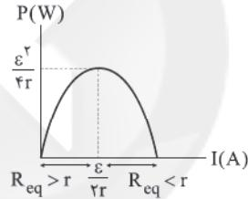
با توجه به نمودار، مشاهده می‌شود که با افزایش شدت جریان از صفر، ابتدا توان خروجی با تری افزایش یافته و سپس کاهش می‌یابد.
