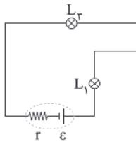
طبق رابطه  $I = \frac{\epsilon}{R_{eq} + r}$ ، با افزایش مقاومت معادل مدار، جریان عبوری از باتری کاهش یافته و نور لامپ  $L_3$  کاهش می‌یابد.
