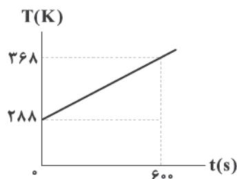
$$\text{توان سماور چند کیلووات است؟} \quad (c = 4200 \frac{\text{J}}{\text{kg}\cdot\text{K}}, \Delta T = 368 - 288)$$
